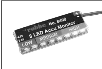
Akkumonitor No. 8409 Der robbe 8-LED Akku-Monitor ist ein präziser, digitaler Spannungsmesser zur Überwachung von Empfängerakkus mit 4,8 V oder 6 V Nennspannung (4 oder 5 zelliger NC / NiMH-Akku).
